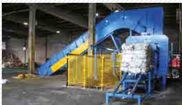
110x110 Legatura orizzontale 5 fili. 110x110 Horizontal tying 5 wires.
