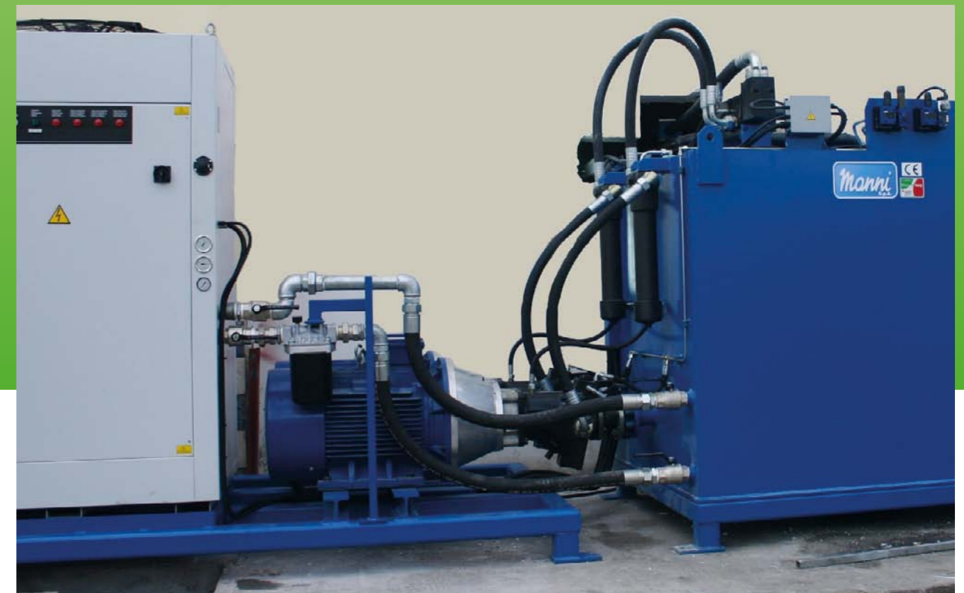
Particolare centrale idraulica con sistema di raffreddamento dell'olio Hydraulic unit with cooling system of the oil
