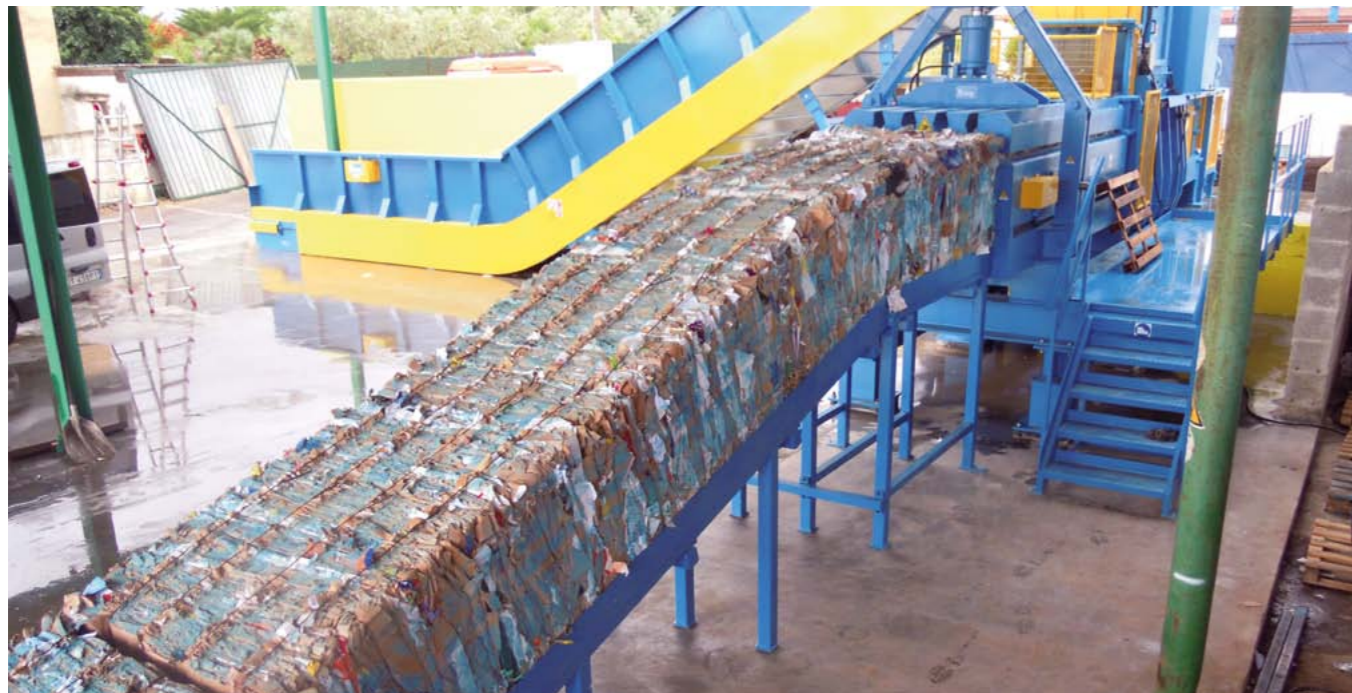
Pressa PMC WA 60 con nastro di carico PMC WA 60 press with loading belt
