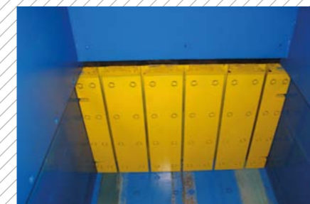
Particolare testata carrello spintore e pareti vano di pressatura intercambiabili Front pusher trolley and interchangeable pressing daylight walls
