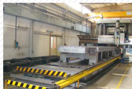
Fresatura interna della struttura Internal milling of the structure
