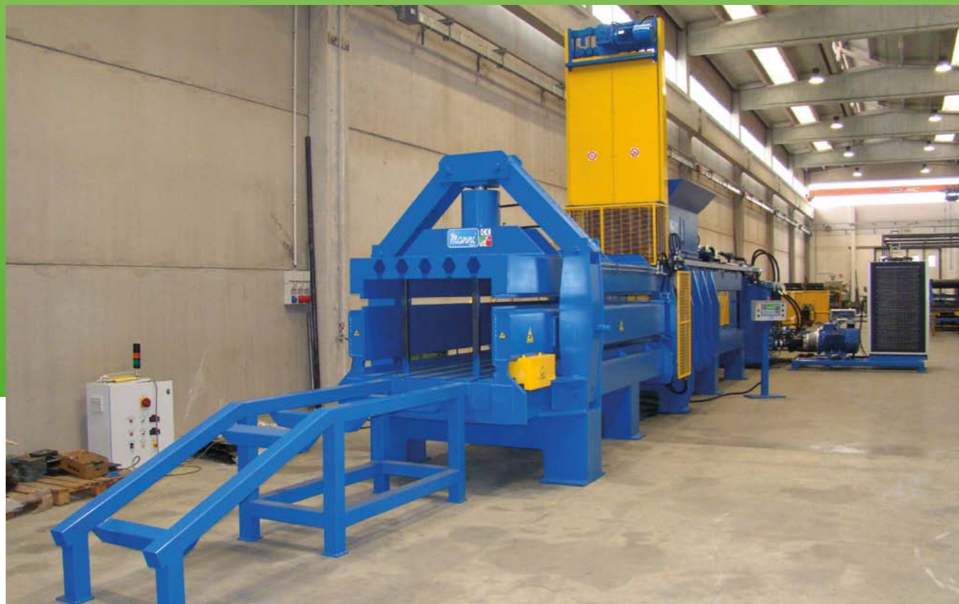
Pressa compattatrice con sistema refrigerazione olio del circuito idraulico Compactor press with oil cooling system of the hydraulic circuit.
