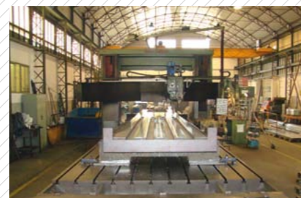
Foratura interna della struttura Internal drilling of the structure
